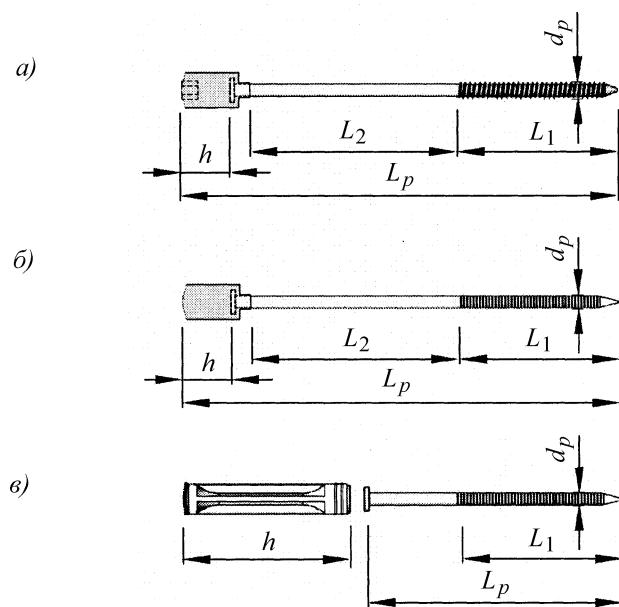
*a)* стальной распорный элемент закручиваемого типа; *б)* стальной распорный элемент забивного типа и распорной зоной с накаткой или резьбой; *в)* стальной распорный элемент с изолирующей заглушкой;
