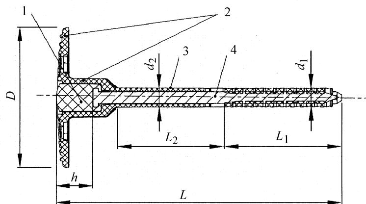
1 — термоголовка; 2 — тарельчатый элемент; 3 — втулка тарельчатого дюбеля; 4 — распорный элемент анкера;
