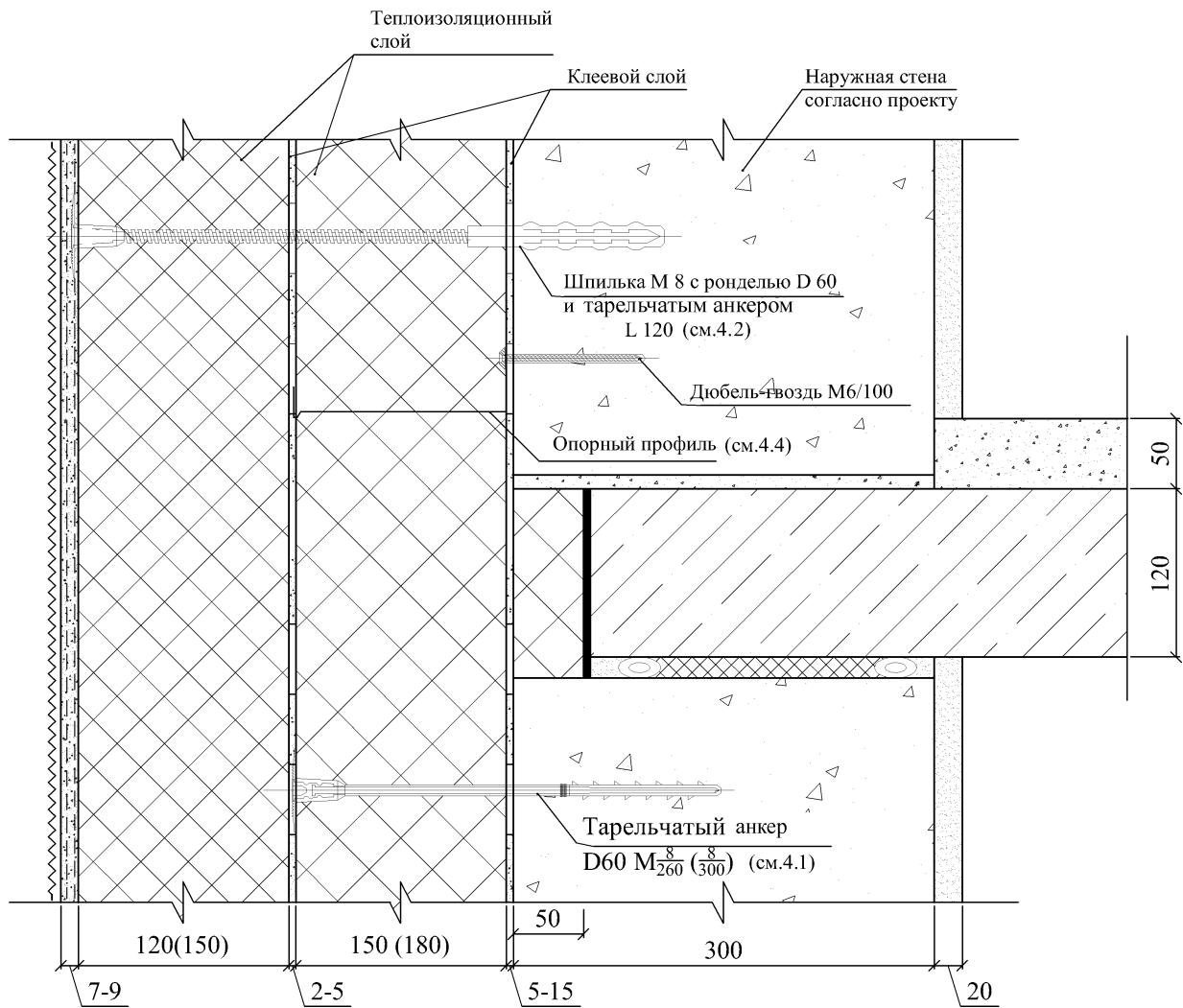
**A.3.14 Конструктивное решение крепления двухслойной теплоизоляции при выравнивании основания**
