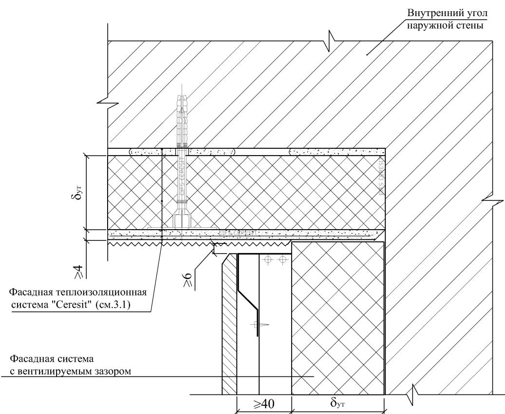
**A.3.8 Установка навесных элементов фасада (вывески, кронштейны, маркизы) на энергосберегающие анкеры с терморазрывом**
