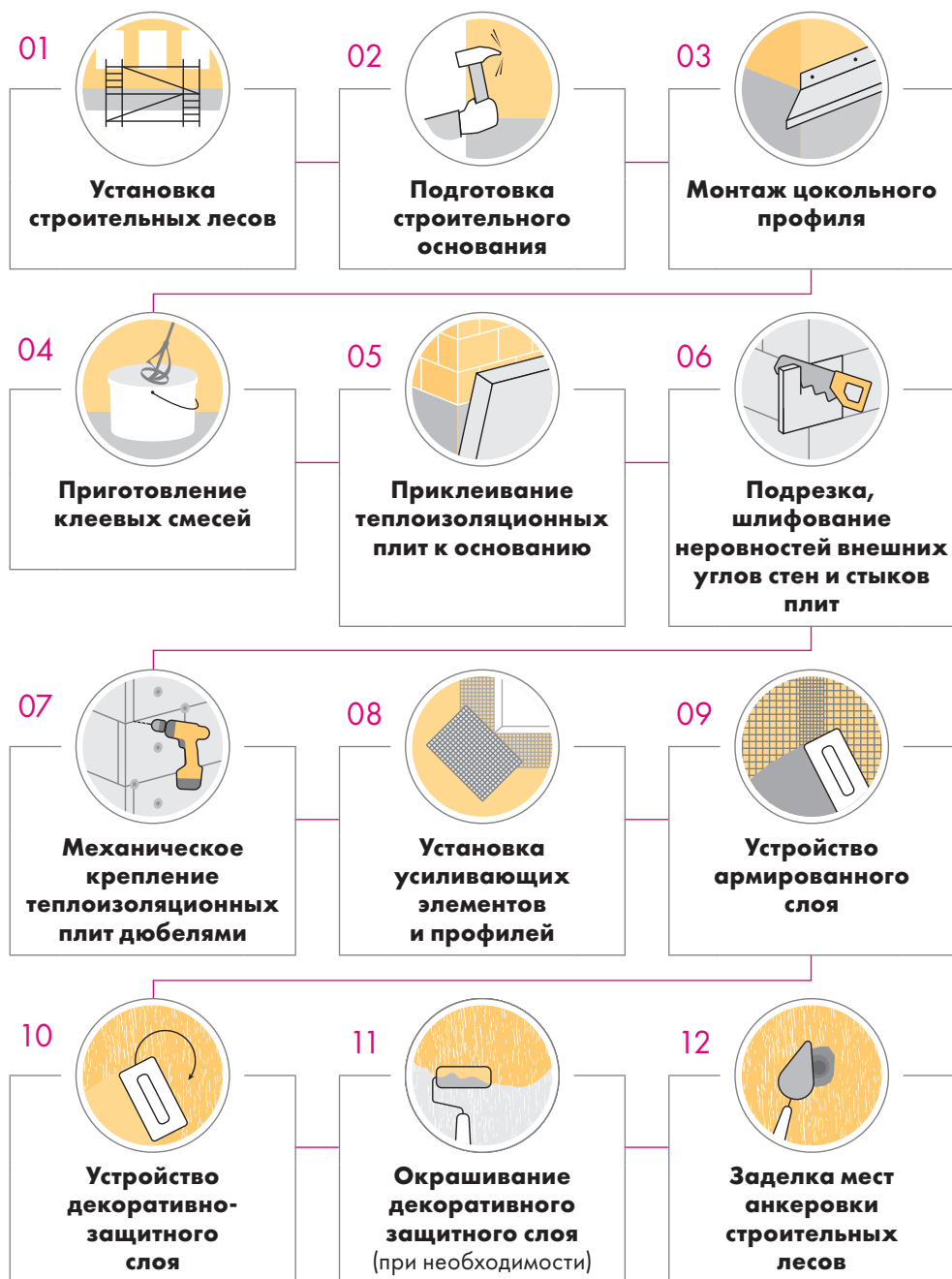
Табл. 4 Перечень технологических операций монтажа теплоизоляции
