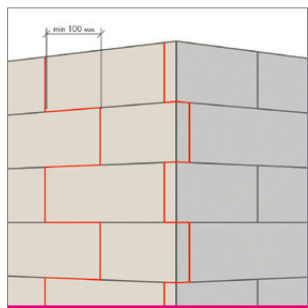
Рис. 19 Порядок размещения плит и перевязка
