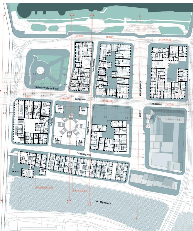
Рис. 10. Экспериментальный проект «8 кварталов Альтштадта». План типовых этажей воссоздаваемых зданий. М 1:200. 2016 год
