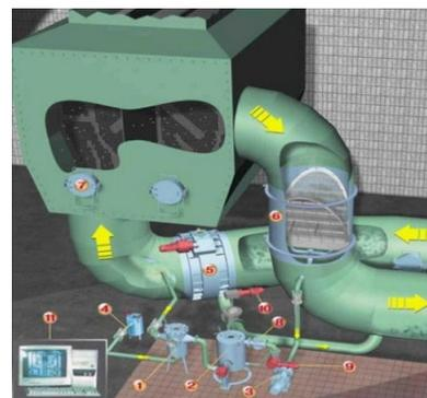
Шариковая очистка конденсаторов: снижение расхода тепла на турбоустановку на **1-2%**, прирост электрической мощности турбины до **1,8%**
