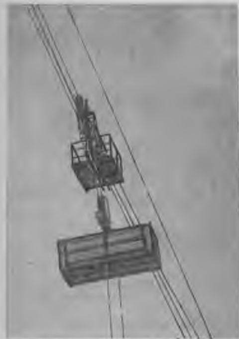
Рис. 36. Большой контейнер кабель-крана.
