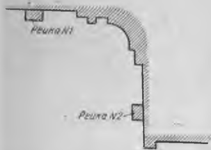
Рис. 47. Вытягивание карниза и половины прогона.
