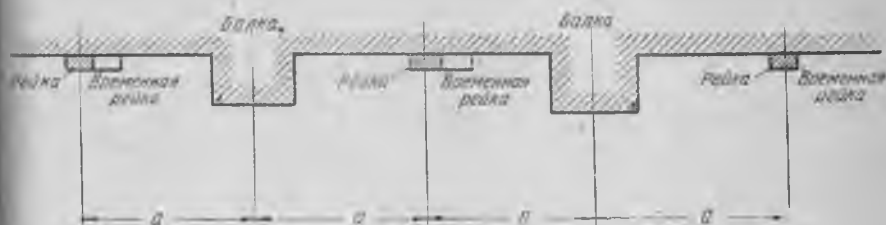
Рис. 48. Навешивание реек „прямое“.
